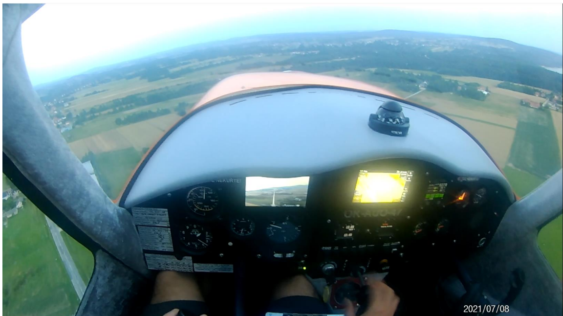
Rysunek 3.9. Kadr z nagrania video obejmującego przestrzeń przed samolotem, parametry lotu oraz parametry silnika w samolocie Skylane Towmaster (fotografia własna)
