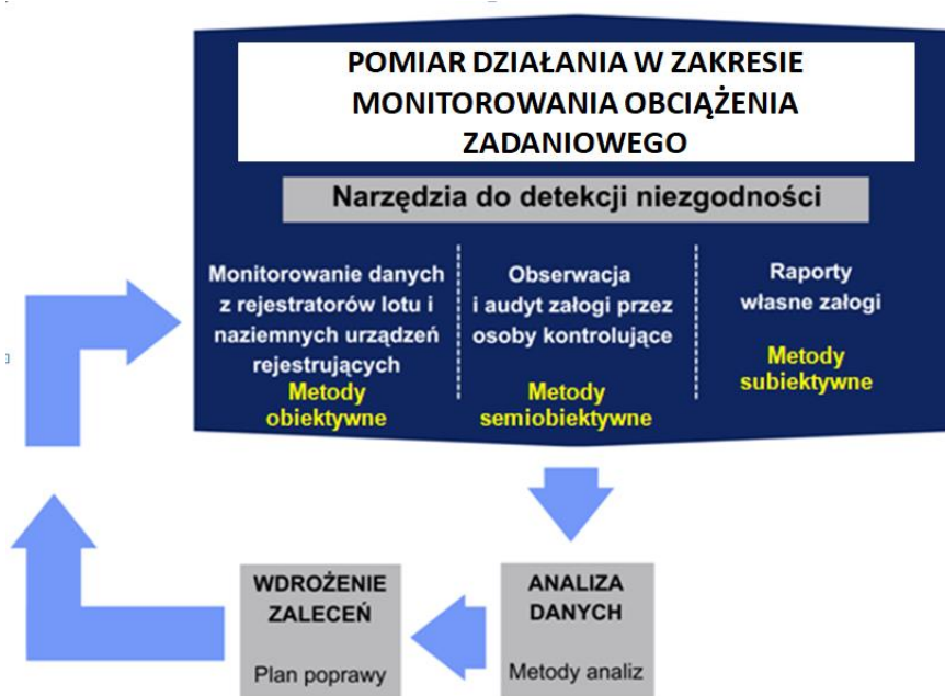
Rysunek 4.1. Zmodyfikowana koncepcja monitoringu stanu bezpieczeństwa i jakości wykonywania operacji lotniczych (Opracowanie własne na podstawie: Speyer, J.-J., 2002), The Flight Operations Monitoring System. )
