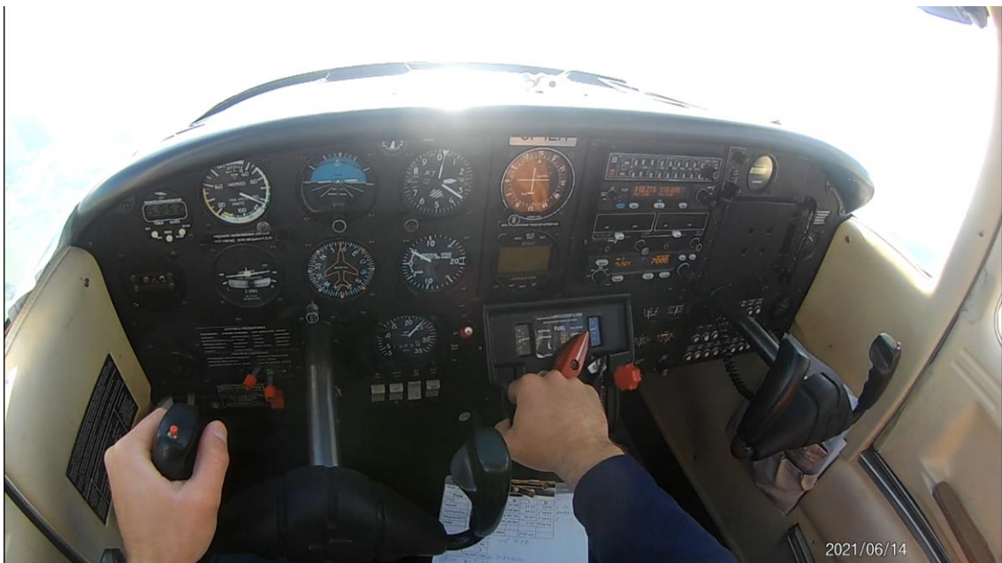
Rysunek 3.10. Kadr z nagrania video ukazujący położenie przełączników i sterownic, parametry lotu oraz parametry silnika w samolocie Piper PA-38 Tomahawk (fotografia własna)
