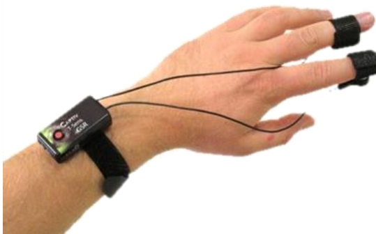
Rysunek 1.32. Przykładowe urządzenie mierzące reakcję skórno-galwaniczną (Wearable sensing, 2023)
